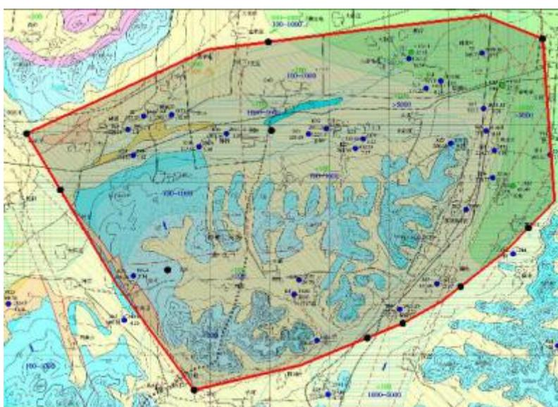
图 5.4-5 承压含水层参数分区
