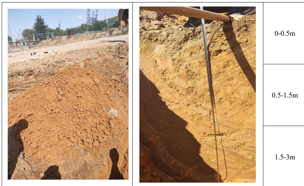
图 5.6-1 土体构型（土壤剖面）
