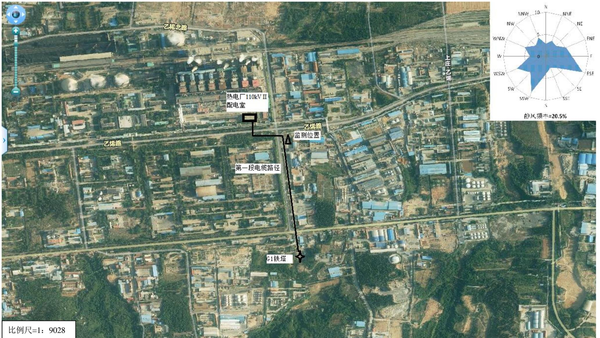
附图 6-1 第一段电缆路径图
